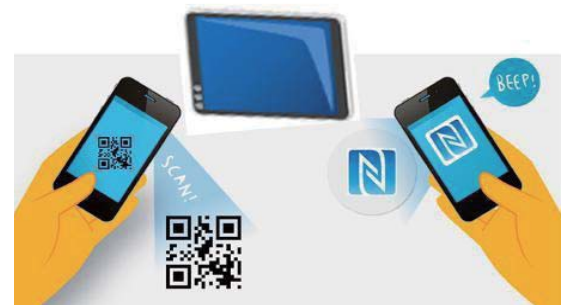
圖 1. 手機掃描 QRCode 或感應 NFC Tag，自動連結 Bluetooth 或 Wi-Fi Direct 設備。
