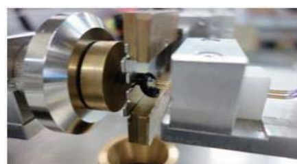
圖 1. 具 8 根探針的自動掃頻檢測機構
