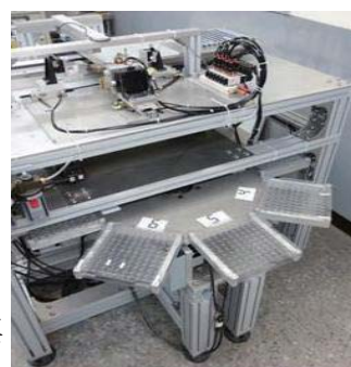
圖 1. 具 8 根探針的自動掃頻檢測機構
